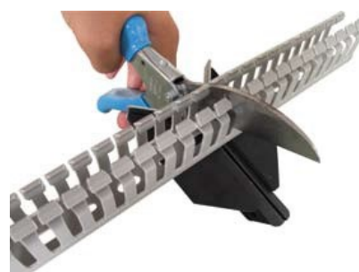
Pince pour sectionner les goulottes à 90° ou 45° pour des largeurs de 25 à 80 mm réf. PINGO
