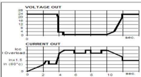
Dans le cas de court-circuit ou de surcharge, le courant de sortie est maintenu à une valeur haute avec une tension proche de zéro.
