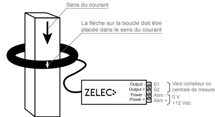
Câbler output S1 de la boucle sur l'entrée S1 du compteur, output S2 sur l'entrée S2.
