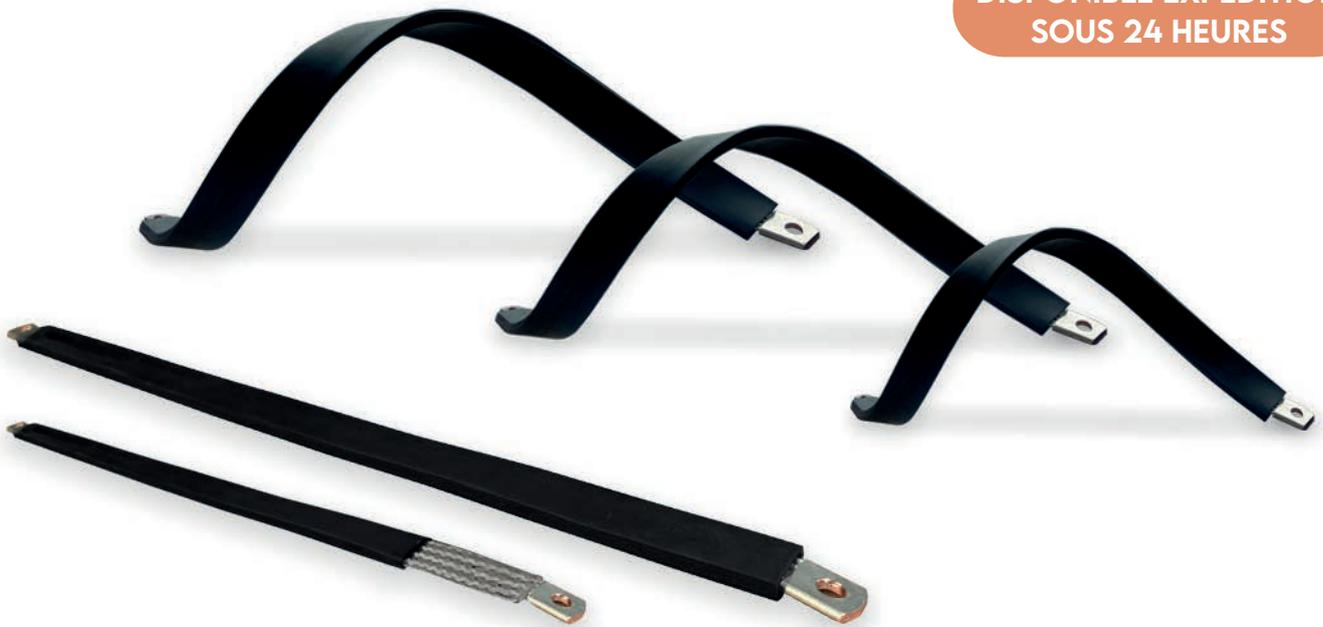
Les tresses en cuivre isolées permettent de réaliser des liaisons de puissance entre des jeux de barres et des appareils, contribuant ainsi à garantir des connexions électriques sûres et efficaces. Notre gamme est composée de 36 références permettant de couvrir une plage allant de 125 à 1000 A et de longueur 230 à 1030 mm en pas de 100 mm.
