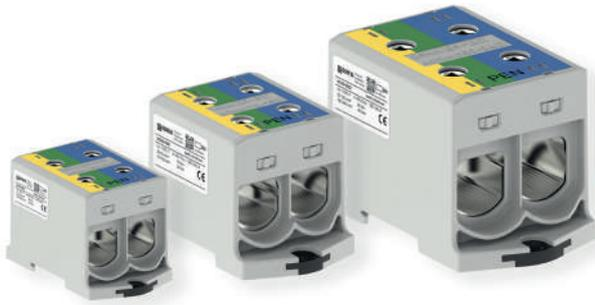
Les blocs de jonction PEN sont adaptés aux réseaux fonctionnant en régime de neutre TN-C (terre et neutre confondus). La mesure du neutre se fait par déconnexion du câble.
