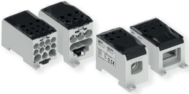
La gamme de répartiteurs unipolaires s'étend de 160 A à 600 A. Ils sont encliquetables sur rail DIN et leurs pattes de fixation permettent un montage simple et rapide sur platine ou plaque de fond. L'arrivée se fait en câble cuivre ou aluminium. Les départs s'effectuent quant à eux en câbles cuivre rigides ou souples avec embouts. En option, les adaptateurs offrent la possibilité d'arriver avec une barre flexible ou une cosse.
