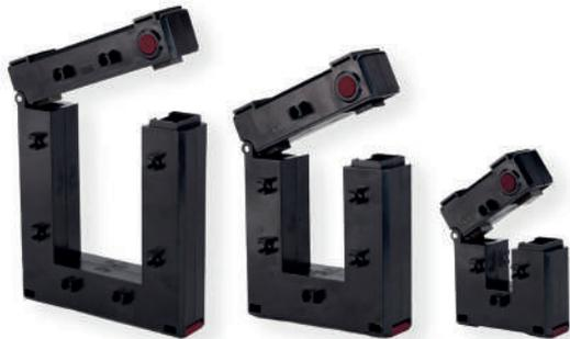
Les transformateurs de courant ouvrants SPB délivrent au secondaire un courant proportionnel au courant primaire. Ils sont utilisés pour connecter divers appareils de mesure, tels que des compteurs d'énergie, des centrales de mesure ou des convertisseurs.
