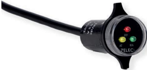
Les voyants MAD indiquent, de manière claire et précise la position « ouverte », « fermée » ou « défaut », d'un disjoncteur grâce à 3 leds distinctes. De plus, les 2 relais intégrés permettent de faire un report à distance sur une supervision des positions du disjoncteur.
