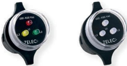
Les voyants Trileds® Zelec se raccordent directement sur bornes, sur un réseau triphasé (Tri) ou un réseau tétraphasé (Tri + neutre). Ils disposent d'une profondeur compacte de 33 mm et se montent grâce à un seul perçage de 30,5 mm sur les coffrets modulaires et armoires électriques.
